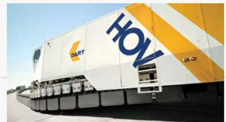
3. Em uma passagem, a barreira é transferida até 7,3 m e gentilmente colocada sem danificar a estrada, em velocidades de até 16 km/h.
