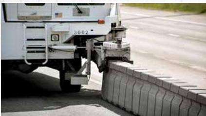
1. Seções de um metro de barreiras de concreto, altamente reforçadas, são fixadas em cada extremidade para formar uma barreira de proteção contínua. As barreiras possuem a parte de cima em forma de "T", que age como uma superfície de elevação para o Sistema Road Zipper.
