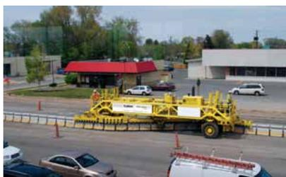
↗ O Sistema Road Zipper acelera a construção segura em uma zona de trabalho ao criar espaço para equipamentos de grande porte
